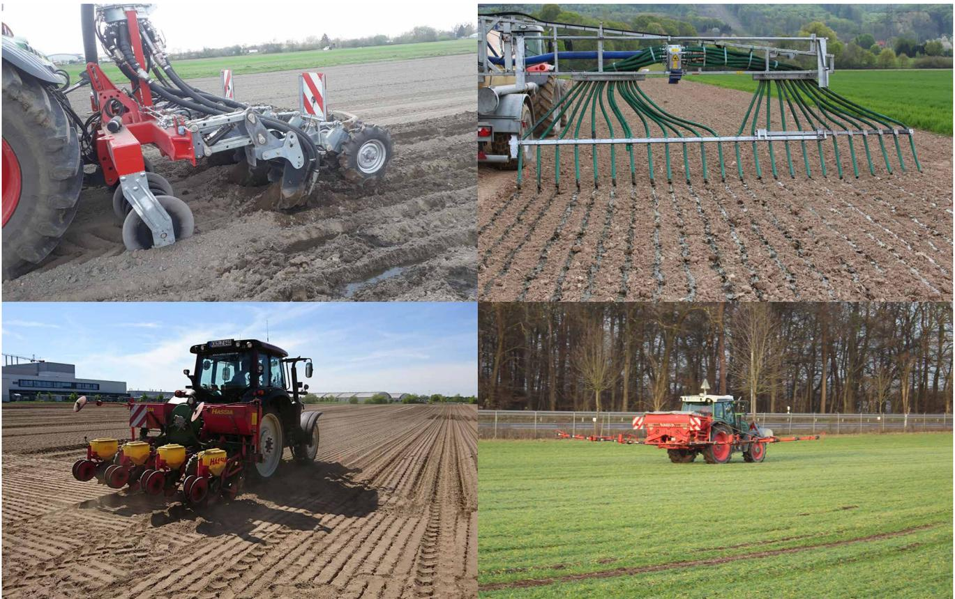
Abbildung 8: Kombination aus Ausbringungstechnik und verwendeter Düngerart. Organische Depot- bzw. Unterfußdüngung (oben, links, Foto: Tobias Mann/LTZ), organische Breitverteilung mittels Schleppschauch (oben rechts, Foto: Sebastian Weisenburger/LTZ), mineralische Depot- bzw. Unterfußdüngung mittels Einlegescharen bei Maissaat (unten links, Foto: Kerstin Stolzenburg/LTZ) und mineralische Breitverteilung mittels pneumatischem Schleuderstreuer (unten rechts, Foto: Hanna Uckele/LTZ).
