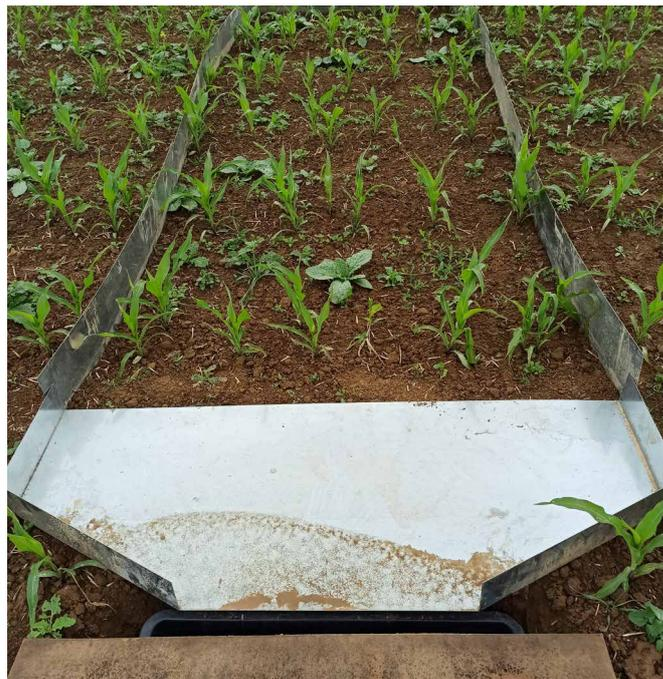
Abbildung 7: Ableitblech-Installation zur Erosionsmessung in der Frühjahrsblütmischung. (Foto: Sabine Kurz/HfWU)
